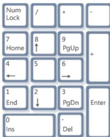
Para usar o teclado numérico para digitar números, pressione Num Lock. A maioria dos teclados tem uma luz que indica se Num Lock está ligado ou desligado.
